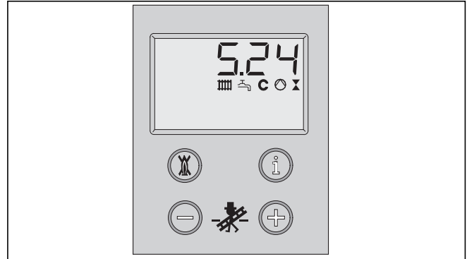
Fig. 5.6 Indicația display-ului la încărcarea boilerului
