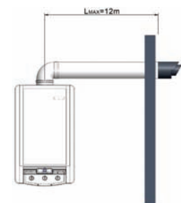
Коаксиальная труба в горизонтальном исполнении, герметичная (с одной опорой) L макс. , расстояние 12м, Ø80/125
