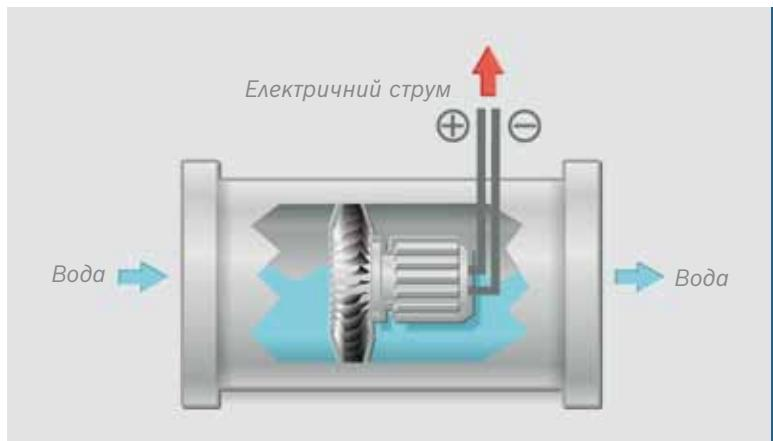
В основі роботи запалювання HydroPower покладено простий принцип: у водяному контурі колонки встановлено гідродинамічний генератор. Коли вода проходить через нього, він виробляє електроенергію для запалювання пальника.
