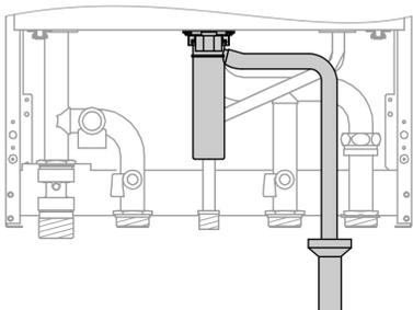
Подключить трубопровод для отвода конденсата к канализационной сети с созданием уклона и с воздушником.
