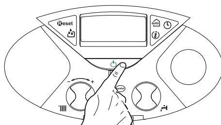
Полное выключение котла осуществляется переводом внешнего двухполюсного выключателя в положение OFF (ВЫКЛ); дисплей при этом гаснет.
