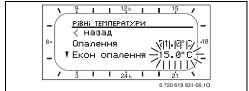
Рис. 9 Поле введення бажаної температури приміщення
