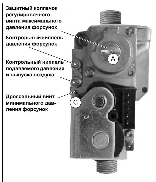
Рис. 45 Настройка давления форсунок
