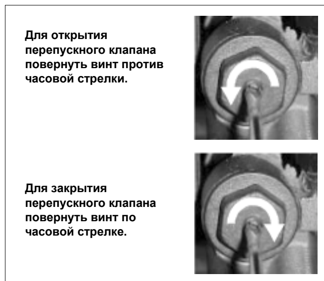
Рис. 29 Настройка перепускного клапана
