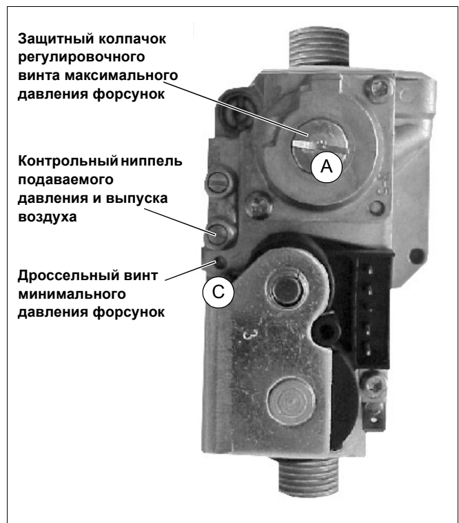
Рис. 43 Настройка давления форсунок
